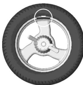
Рисунок 6.5 – Груз установлен в «12 часов»
